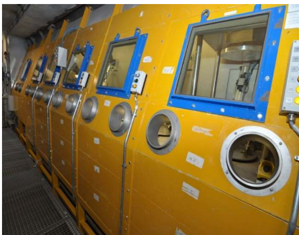
Бокс сортування, розташування робочих місць
