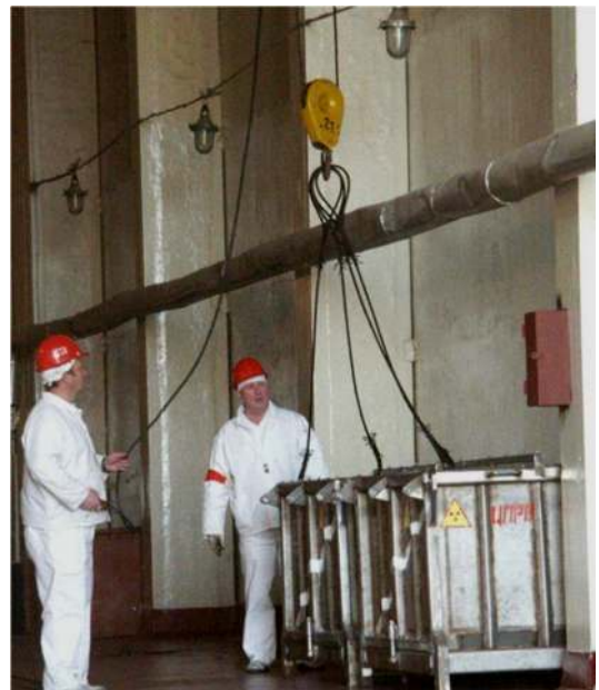
Контейнер-збірник ТРВ перед транспортуванням у СТРВ СК
