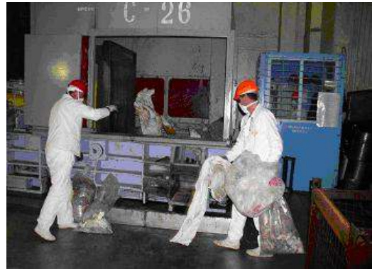
Установка для пресування РАВ
