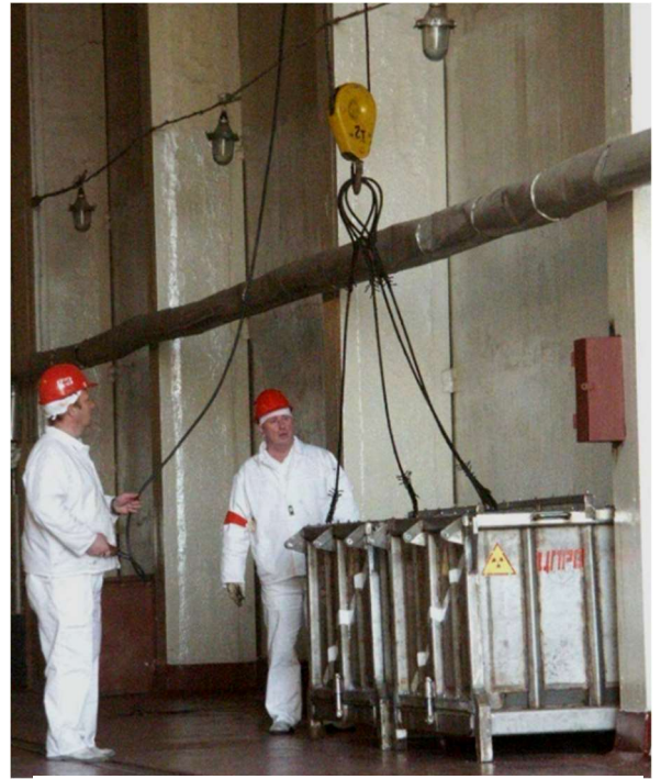
Контейнер-збірник ТРВ пелел транспортуванням в СТРВ СК
