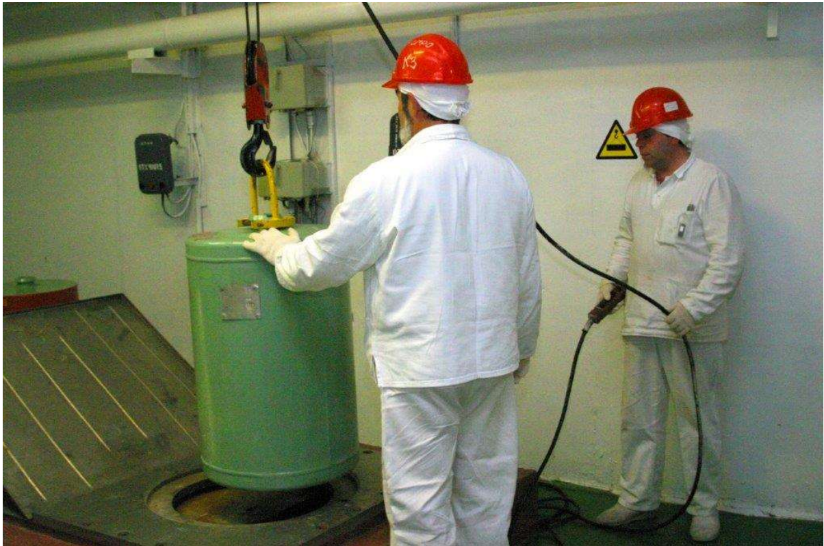
Стропування контейнера з СП
