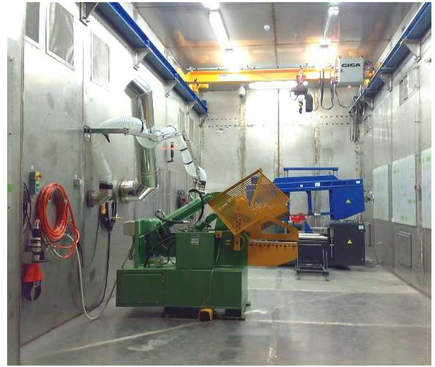
Кесон установки фрагментації (вигляд всередині)
