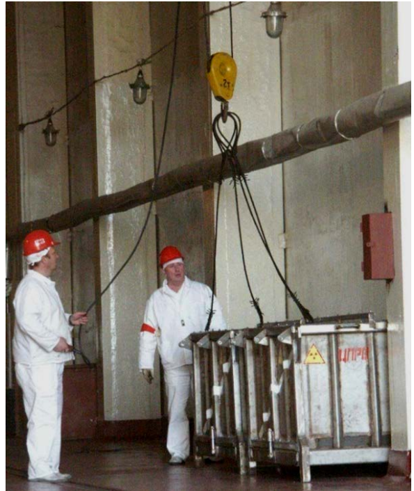
Контейнер-збірник ТРВ перед транспортуванням у СТРВ СК
