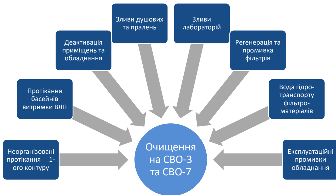
Джерела утворення трапних вод на АЕС
