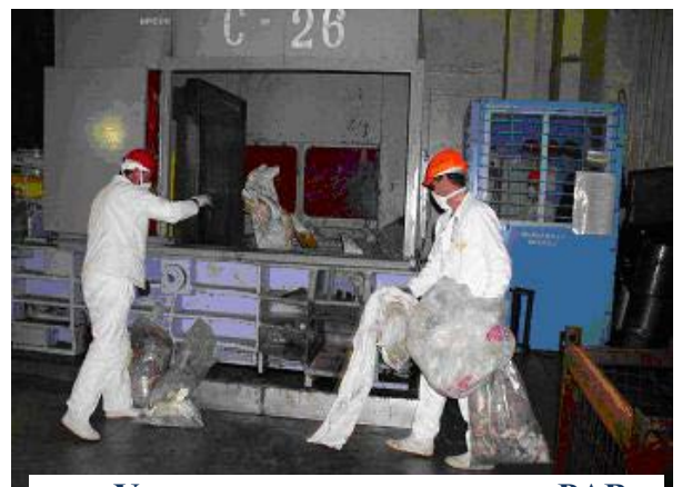
Установка для пресування РАВ
