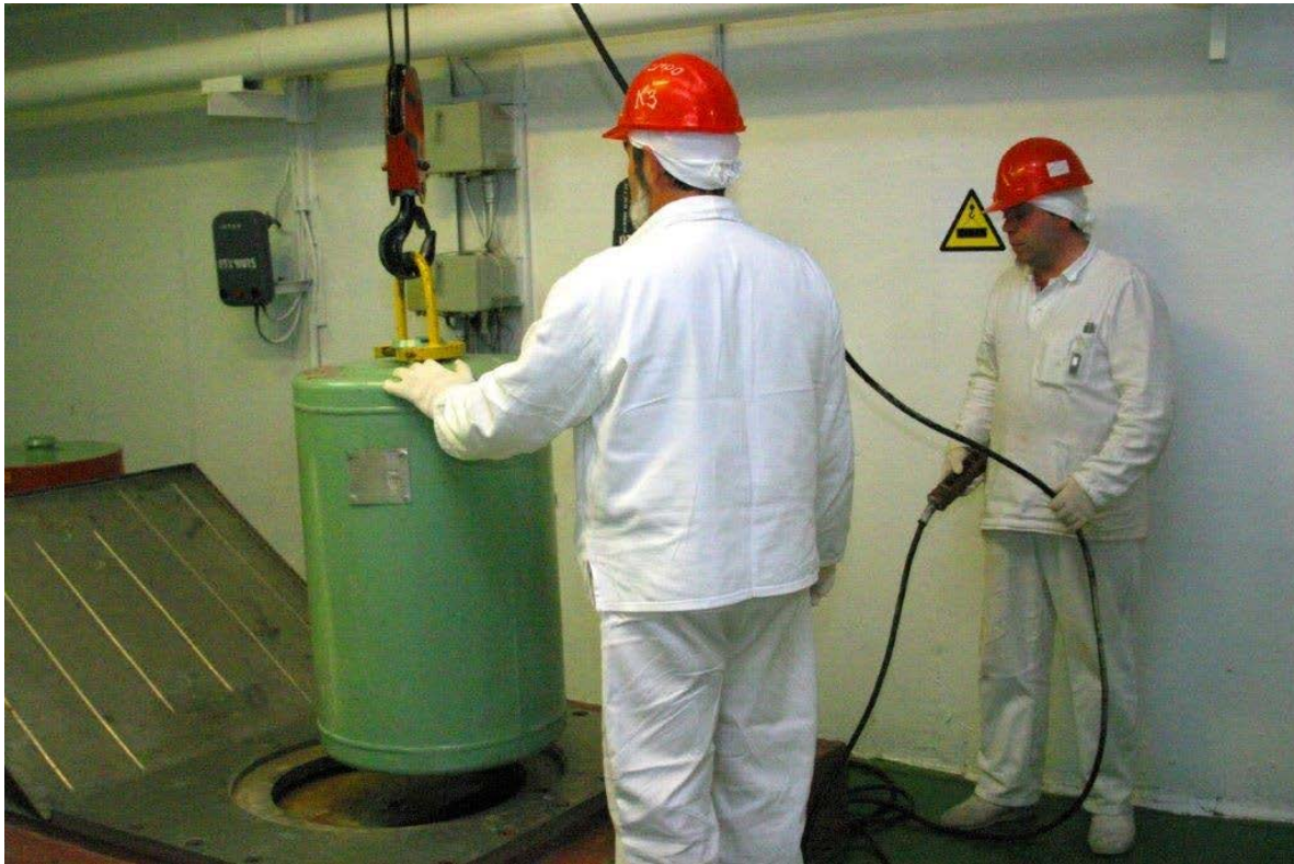
Стропування контейнера з СП
