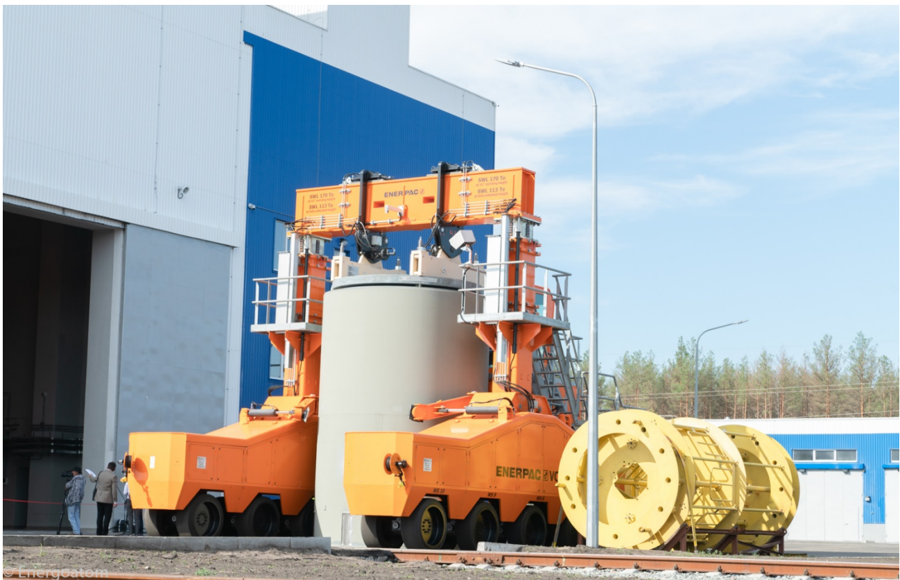
Вертикальний колісний транспортер контейнерів зберігання ВЯП
