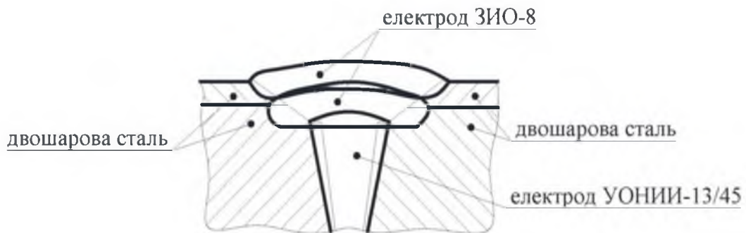
Рисунок 6.5 – Зварне з'єднання деталей двошарових сталей між собою з відновленням плакваного шару
